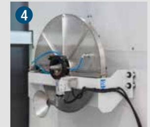
Station de changement automatique des outils pour diam. jusqu'à 1200 mm
