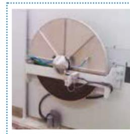
Disque jusqu'à un diam. de 1200 mm avec changement automatique d'outils
