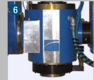
Électrobroche attachement ISO50 - Puissance 23 kw - Couple 220 Nm
