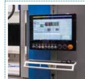
Nouvelle console intégrée à la machine avec écran 21,5" et fonction touch
