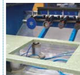
Utilisation de disques et de meules pour la réalisation et le polissage de profils internes ayant des arêtes vives
