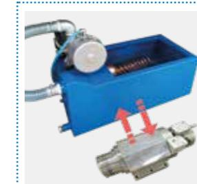
Nouveau groupe frigorifique pour refroidir simultanément l'électrobroche et la pompe à vide (option)
