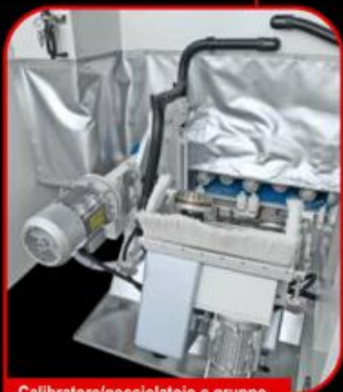
Calibratore/gocciolatoio e gruppo sgrossatura aperto Calibrator/water drip unit and open roughing group
