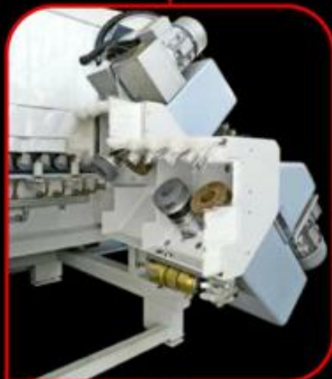
Gruppo smussi aperto Open bevelling spindles group
