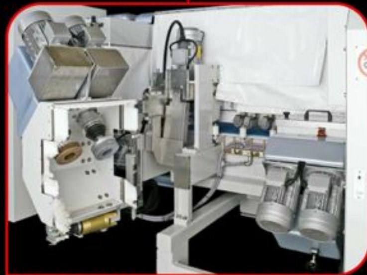
Calibratore / gocciolatoio e gruppo bisellatura aperto Calibrator / water drip unit and open roughing group
