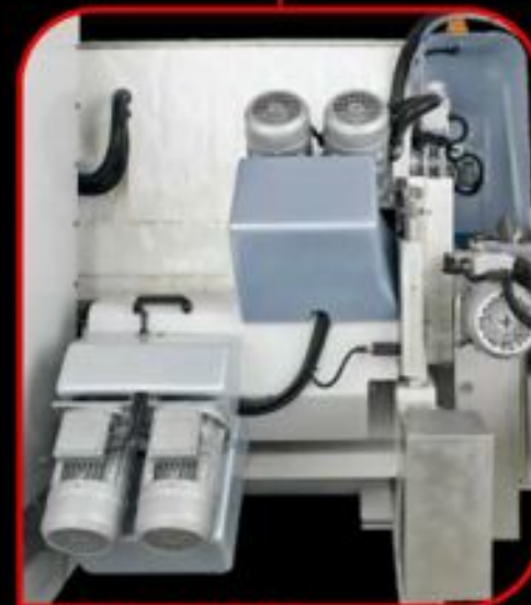
Gruppo smussi chiuso Closed beveling spindles group
